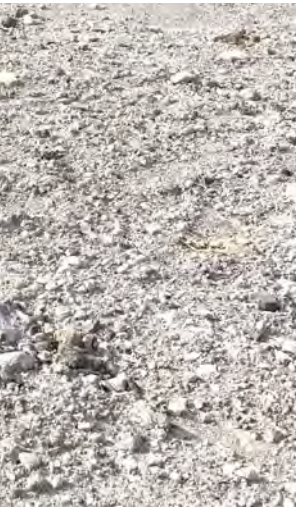
karakter af nedknust beton og småsten.
